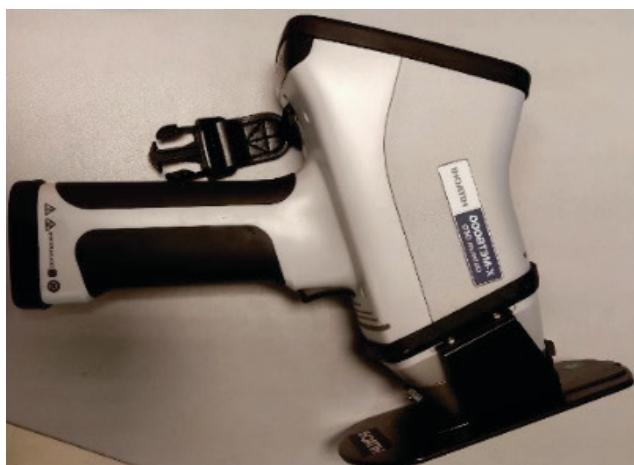
Slika 1. Prijenosni XRF analizator X-MET8000 Optimum GEO korišten za analizu uzorka
